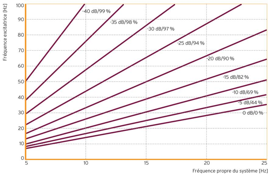
Figure 4 : Réduction de la transmission des vibrations mécaniques à l'aide d'un appui élastique en Sylomer® SR 1200 sur une structure rigide.
