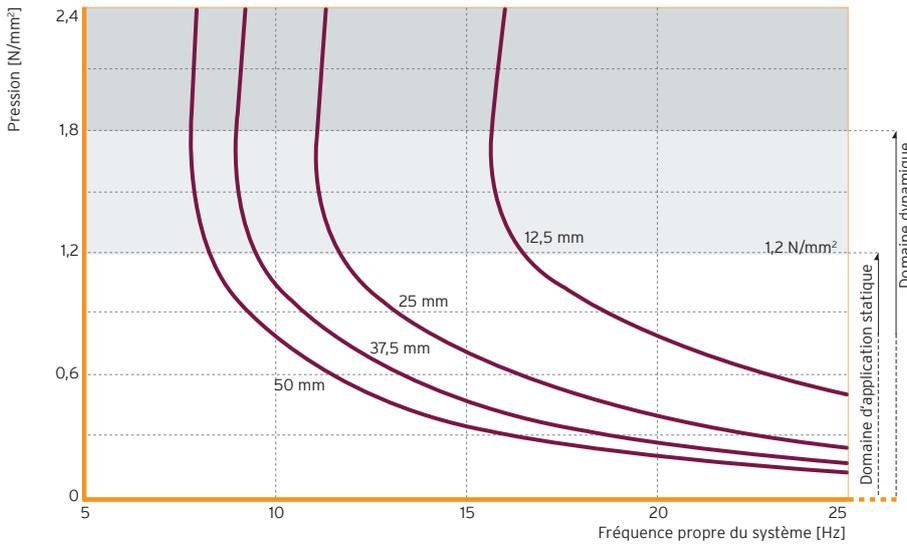
Figure 3 : Fréquences propres d'un système vibratoire à un degré de liberté, comprenant une masse rigide et un appui élastique en Sylomer® SR 1200 sur structure rigide.
