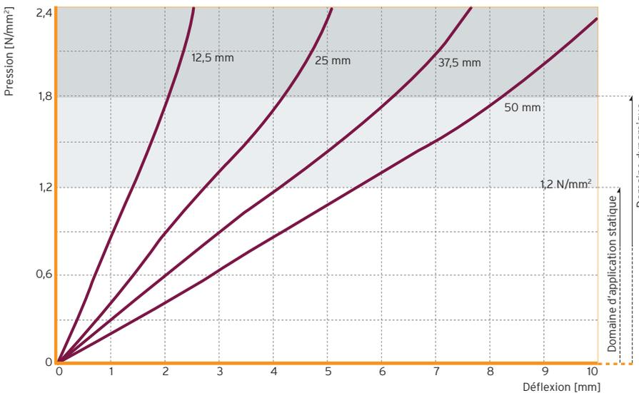
Figure 1 : Courbe de déflexion quasi-statique avec une vitesse de charge de 0,12 N/mm<sup>2</sup>/s
